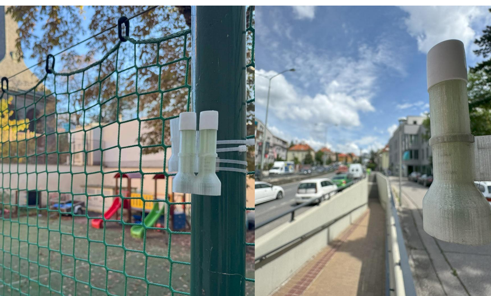
Obr. 3 a 4 Difuzní pasivní vzorkovače a příklady jejich umístění
